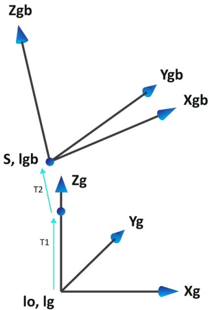
**Abbildung 8.** Darstellung der Quellposition, wobei  $I_o$  = Isozentrum,  $S$  = Quelle,  $gb$  = Gimbal-Koordinatensystem,  $g$  = Gantry-Koordinatensystem,  $T_1$  = erste Translation und  $T_2$  = zweite Translation.
