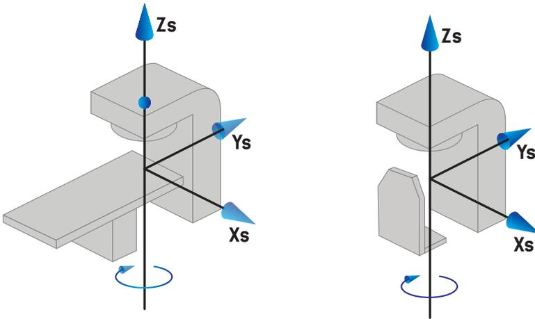
**Hinweis:** Wenn der Linearbeschleuniger konfiguriert wurde, um den Tischwinkel gemäß IEC 61217 zu benutzen, wird die Einheit der Winkel in [deg] angegeben.
