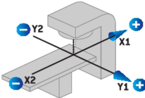
**Abbildung 13.** Die Blenden- und MLC-Kennzeichnungen (IEC 601).
