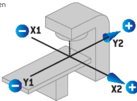
**Abbildung 12.** Die Blenden- und MLC-Kennzeichnungen (IEC 61217).
