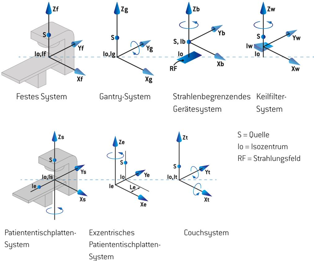
**Abbildung 4.** Das Gerätekoordinatensystem gemäß den IEC-61217-Standards.
