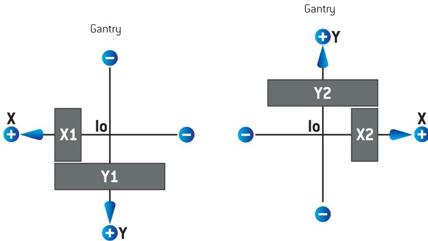
**Abbildung 6.** Die Positionen des Kollimators im Beam's Eye View gemäß der Nicht-IEC (Varian-Standard). Beachten Sie, dass die im Beam's Eye View in RayStation dargestellten Koordinaten immer das IEC 61217-Koordinatensystem verwenden.
